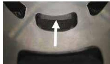
La brida de la toma de escape puede tener un acabado fundido o una superficie mecanizada. La superficie mecanizada puede ser plana o mostrar una protuberancia de sellado circular.
