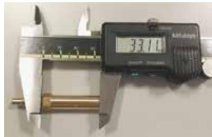
Longitud de la sección inferior: 33,0 +/- 0,45 mm
