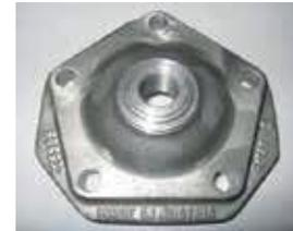
El perfil del inserto de la cámara de combustión debe comprobarse con una plantilla (ROTAX 277390). La rendija de luz entre la plantilla y el perfil del inserto de la cámara de combustión debe ser la misma en todo el perfil.
