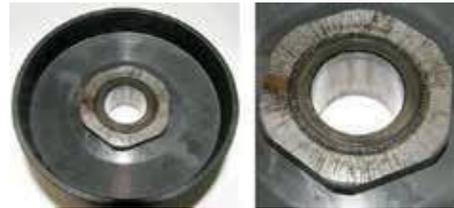
El área de contacto entre el embrague y el tambor del embrague debe seco en cualquier momento - no se permite lubricación.
