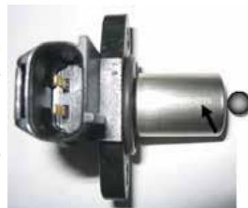
El montaje del captor en el cárter con una junta adicional al anillo de sellado de goma original del pick-up es una especificación legal.
