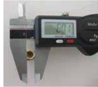
Atomizador, dimensión del orificio transversal: 5,0 +/- 0,15 mm
