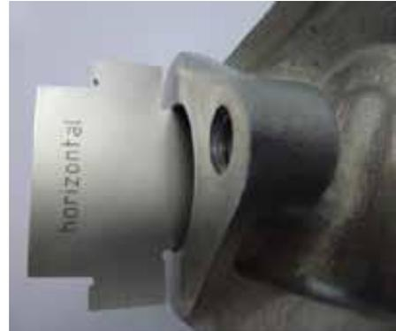
Cilindro 613933 y 613944 solo con puerto de escape totalmente mecanizado por CNC únicamente:
