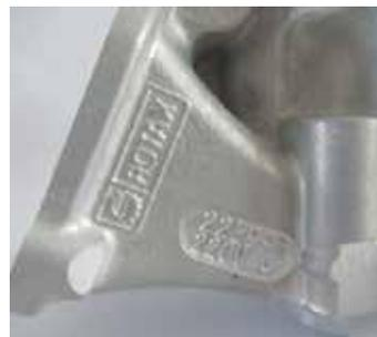
**125 MAX DD2:** Cilindro con un puerto de escape principal y dos puertos de escape laterales y válvula de escape. El cilindro debe estar marcado con el código de identificación 613933 ó 613934.
