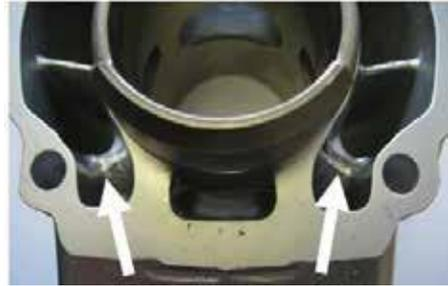
Todos los puertos tienen bordes biselados. No se permite ningún mecanizado adicional.
