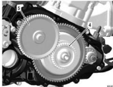
Se puede determinar una relación de transmisión primaria específica para cada evento de carrera mediante un “Boletín”.
