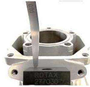
La medición debe realizarse fuera del área de contacto de la válvula de escape indicada en rojo.
