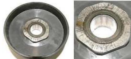
La zona de contacto entre el embrague y el tambor del embrague debe ser seco en cualquier momento - no se permite lubricación.
