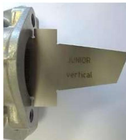
Cilindro 413531 solo con puerto de escape totalmente mecanizado por CNC únicamente:
