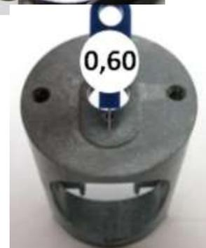
Orificio vertical de los insertos del carburador
