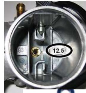
Orificio angular de los insertos del carburador
