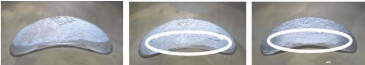
El puerto de escape puede mostrar un pulido manual parcial realizado por el fabricante para eliminar defectos de fundición menores y/o para eliminar la rebaba de NIKASIL al final del revestimiento de NIKASIL (ver imagen superior derecha).
